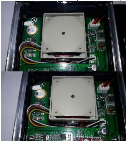
4- Desconectar el cable de video/alimentación del CCD:
