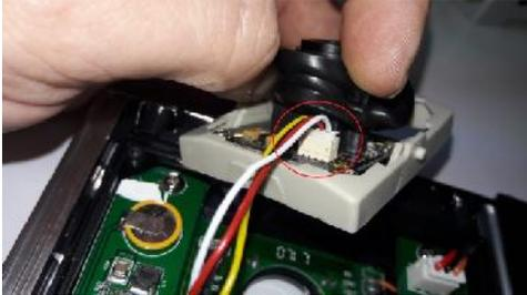
5- Retirar los 4 tornillos para liberar el CCD del soporte plástico, retire el CCD del soporte:
