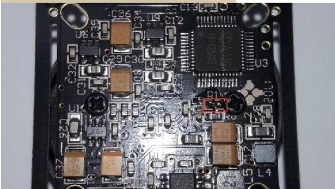
7- Una vez retirado el puente, montar el CCD en el soporte, reconectar el cable de video/alimentación, colocar el conjunto en el panel y colocar la cubierta posterior del panel.
