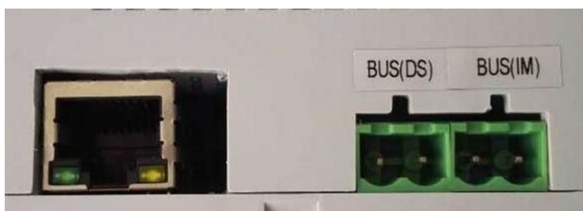
RJ45 : Conectar a la RED o convertor a fibra óptica.
