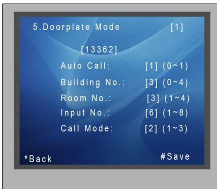
En ese caso la dirección del panel exterior de puerta común es 23, y del VSP 806 y el edificio la dirección es 11. Si se desea llamar monitor de 01 en el panel exterior común debe introducir 011001 para llamar monitor de 01 en edificio.
