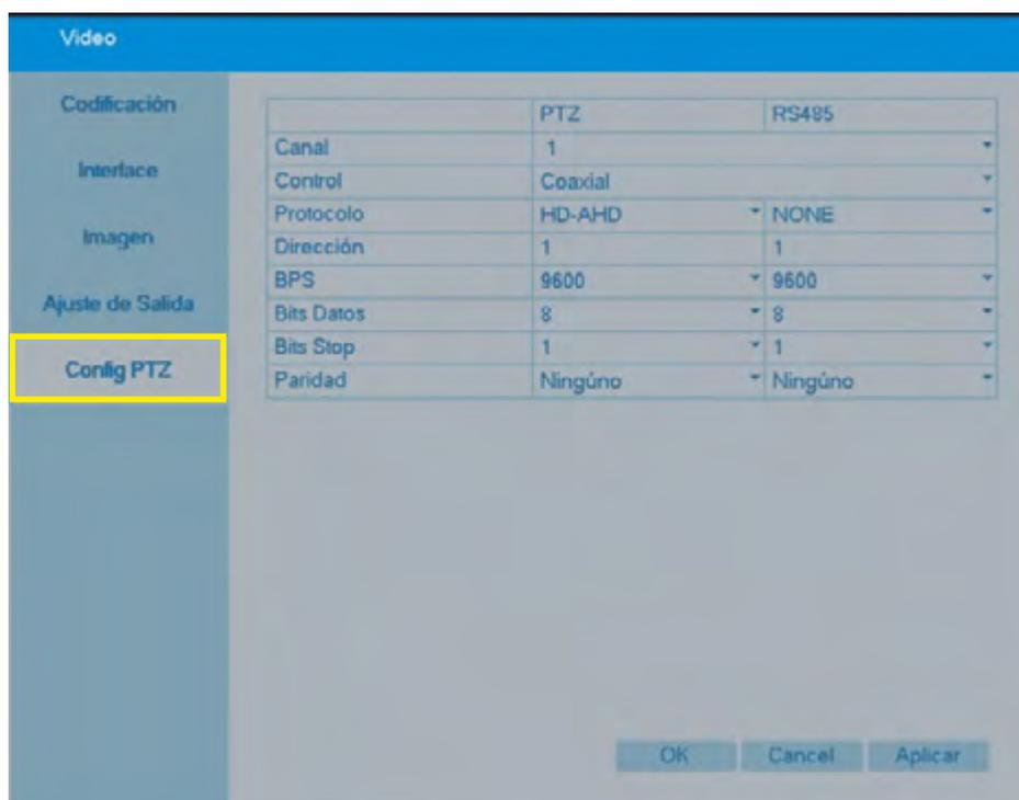
5. Seleccione el canal y configure los mismos parámetros que se muestran a continuación para poder acceder a la configuración de la cámara por OSD.
