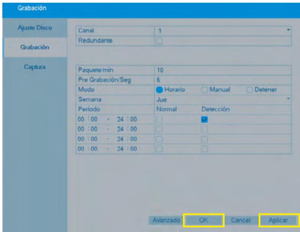
**5. Seleccione el canal donde se encuentra conectada la cámara a programar y configure los mismos parámetros que se muestran a continuación para poder acceder a la configuración de la cámara por OSD.**
